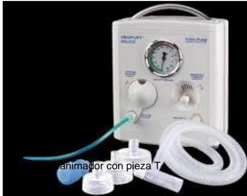
Se administra una respiración utilizando un dedo para ocluir y soltar alternadamente una abertura de escape de gas en la parte superior del tapón del reanimador con pieza en T. Cuando se ocluye la abertura, el gas se dirige a través del dispositivo y hacia el bebé. Cuando se suelta la abertura, se escapa un poco de gas por el tapón. La frecuencia se determina por cuán a menudo ocluya la abertura en el tapón y el TI se controla mediante el tiempo durante el cual se ocluye la abertura.
